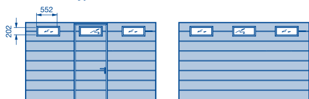
Przeszklenie typu M
