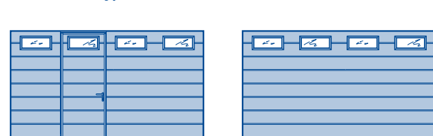
Przeszklenie typu M
